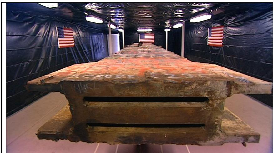
Рис. 32. Фрагмент опоры ядра
